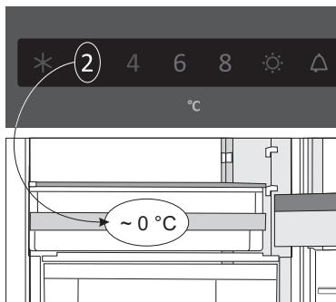
Aby bola teplota v zásuvke **ZeroZone**  $0\text{ }^{\circ}\text{C}$ , odporúčame nastaviť teplotu chladničky na  $4\text{ }^{\circ}\text{C}$ . Teplota v zásuvke **ZeroZone** môže klesnúť pod  $0\text{ }^{\circ}\text{C}$ ; umiestnite preto potraviny citlivé na mrazenie do hornej časti chladničky.
