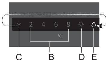
Ak je teplota v spotrebiči príliš vysoká, aktivuje sa akustický alarm (prerušovaný zvuk) a začne blikáť symbol **E**.
